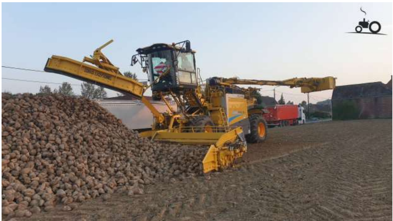
Figuur 16. Laden en partieel reinigen van voederbieten met Ropa Maus (copyright foto tractorfan.nl)
