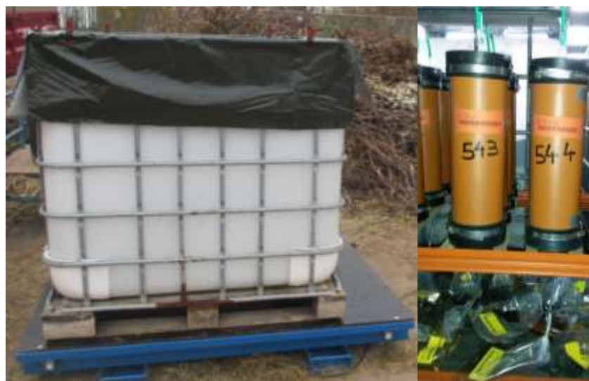
Figuur 31. Links: kubiconainer klaar om in te kuilen. Rechts: microkuil met bovenaan CO 2 -slot en onderaan opvang van sap.
