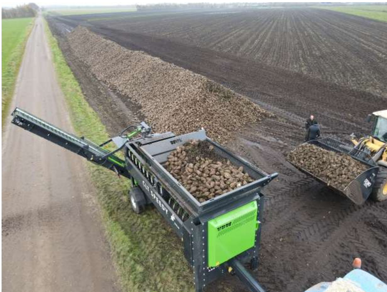
Figuur 17. Overladen en tegelijkertijd reinigen van bieten op het veld m.b.v. Cleaner Tiger Speedy (VDW)
