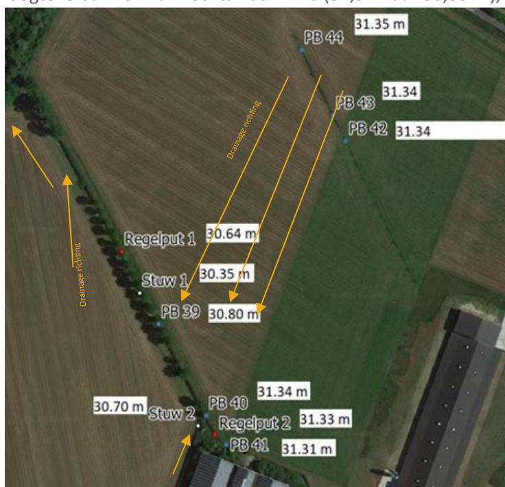
Figuur 1: Situatieschets peilgestuurde drainage en stuwen demoveld Ravels
