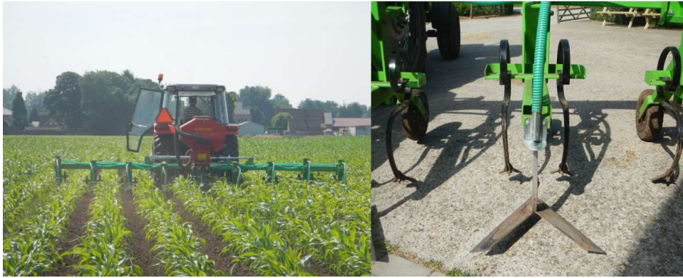
Figuur 13: Schoffelmachine met pneumatische zaaimachine
