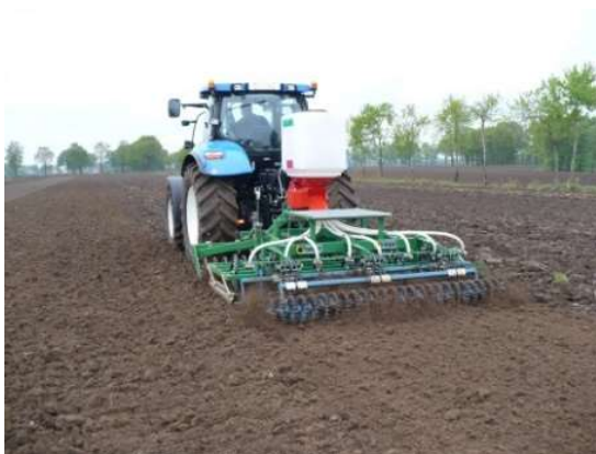
Figuur 14: Gras zaaien met zaadbak op cultivator.
