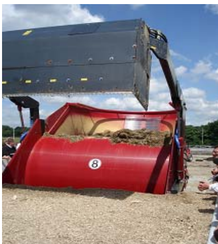
Figuur 7: Zelfladende met snijmes achteraan
