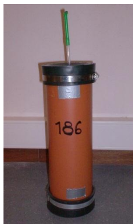
Figuur 1: Microkuil met CO 2 -slot en openingen aan zijkant voor toedienen van aerobe stress
