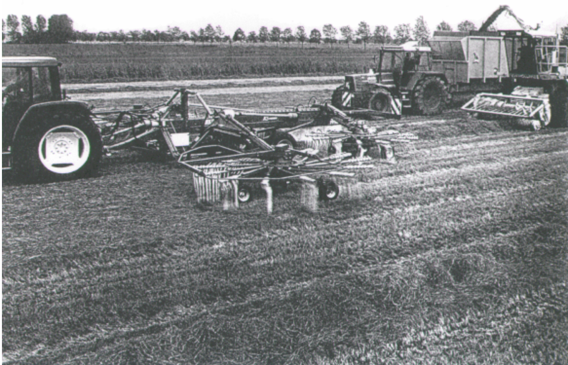
Figuur 6: Vierelementsharken hebben een enorme capaciteit. Ze zijn vooral bestemd voor loonwerkers. Harken en oprapen kan gelijktijdig gebeuren. Gevolg : een maximale droogtijd.
