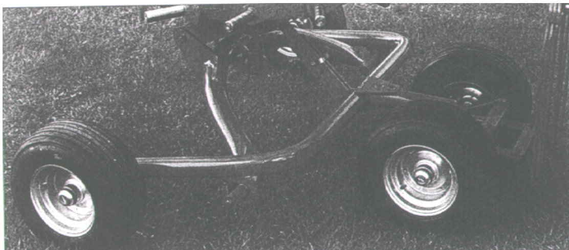
Figuur 16: Het vierwiel Twin tandemstel van Stoll. De twee voorste wielen lopen als een parallele pendelas.
