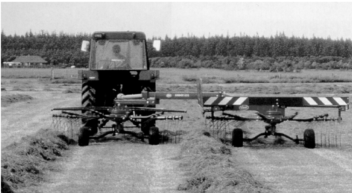
Figuur 13: De Andex 653 van Vicom of de 9065S van Kverneland : het tweede element wordt helemaal naar rechts geplaatst voor de vorming van twee zwaden.
