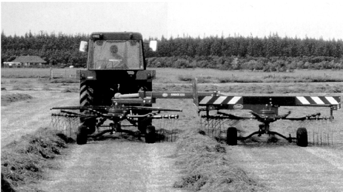
Figuur 5: : Getrokken dubbele hark met zijafleg De hark loopt als een dubbele enkele hark achter de trekker aan (Kuhn : GA 6000)
