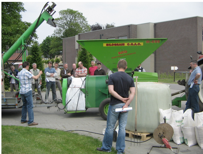
Figuur 1 : Demo te Bocholt met Silograin M-699 voor het pletten en inkuilen van Met deze machine kan men vochtige granen en bijproducten (ook drogere producten)
